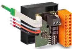
Mit der Universalsteuerung 5/UNI-FT kann alles automatisch gesteuert werden. Sie ist serienmäßig mit Feuchte-Temperaturregelung und Zeitnachlaufmodul ausgestattet und kann auch in den Sommermodus geschaltet werden. Die Universalsteuerung ist eine multifunktionale 12 Volt Steuerung, die mit einem einfachen zweipoligen Serienschalter bedient werden kann.
