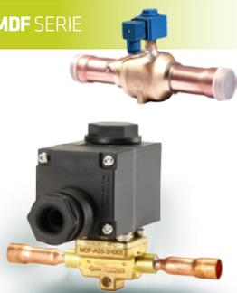
Die Ventile der MDF Serie sind direktwirkende oder vorgesteuerte, stromlos geschlossene Magnetventile, die zur Kältemittelsteuerung in Kühl- und Gefriersystemen, Klimaanlage und Wärmepumpen häufig eingesetzt werden.
