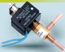
Die kompakten Ventile der FDF2AK Serie sind direktwirkende, stromlos geöffnete Magnetventile, die zur Kältemittelsteuerung in Kühl- und Gefriersystemen, Klimaanlage und Wärmepumpen häufig eingesetzt werden.
