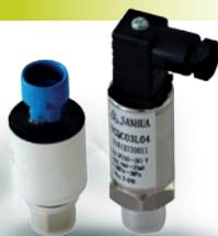
Druckmessumformer kommen in Klima-, Kälte- und Wärmepumpenanlagen häufig zum Einsatz. Die Druckmessumformer YQCC liefern über ein 10-30V DC Eingangssignal ein Ausgangssignal von 4-20mA, welches proportional zum vorliegenden Mediumdruck ist. Das Produkt benötigt keine zusätzliche Verstärkung des Ausgangssignals. Druckmessumformer ermöglichen eine Regelung des Systems und erlauben einen Betrieb unter sicheren und stabilen Bedingungen.
