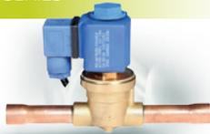
Die Ventile der HDF Serie sind mittels Pilotkolben vorgesteuerte Magnetventile. Diese werden überwiegend zur Kältemittelsteuerung in verschiedenen Anwendungen wie Kühl- und Gefriersysteme, Klimaanlage sowie Wärmepumpen eingesetzt. Die maximal zulässige Medientemperatur von +140°C erlaubt die Installation der HDF Ventile auch in besonders heißen Druckgasleitungen direkt nach dem Verdichter oder auch in Heißgas-Bypass-Leitungen.
