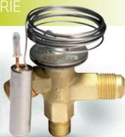
Die thermostatischen Expansionsventile der RFKH Serie sind konzipiert für die Regelung des Kältemittelmassenstromes in den Verdampfer und der Überhitzung am Verdampferaustritt. Sie können für unterschiedliche Kältemittel in einem weiten Einsatzbereich verwendet werden. Typische Anwendungen sind Kälteanlagen wie gewerbliche Kühlschränke und Tiefkühlgeräte, Eismaschinen, Luftentfeuchter sowie Klimaanlagen und Wärmepumpen mit den unterschiedlichsten Verdampfungstemperaturbereichen.
