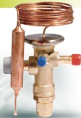
Die thermostatischen Expansionsventile der RFGD Serie sind konzipiert für die Regelung des Kältemittelmassenstromes in den Verdampfer und der Überhitzung am Verdampferaustritt. Sie können für unterschiedliche Kältemittel in einem weiten Einsatzbereich verwendet werden. Typische Anwendungen sind Kälteanlagen wie gewerbliche Kühlschränke und Tiefkühlgeräte, Eismaschinen, Luftentfeuchter sowie Klimaanlage und Wärmepumpen mit den unterschiedlichsten Verdampfungstemperaturbereichen.
