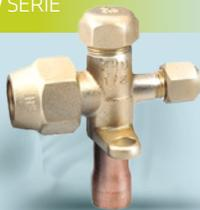
Die Serviceventile der SSV Serie werden häufig zum Verbinden von Innen- und Außengeräten bei Split-Klimaanlagen eingesetzt. Darüber hinaus ist die SSV Serie auch in anderen Kältesystemen vielfältig einsetzbar. Durch Betätigung des Ventilschafts kann der innere Strömungsweg der Ventile geschlossen werden. Die 3-Wege-Ausführung (mit Füllanschluss) kann als Serviceventil für den Anschluss von Vakuumpumpen oder zur Befüllung mit Kältemittel verwendet werden.
